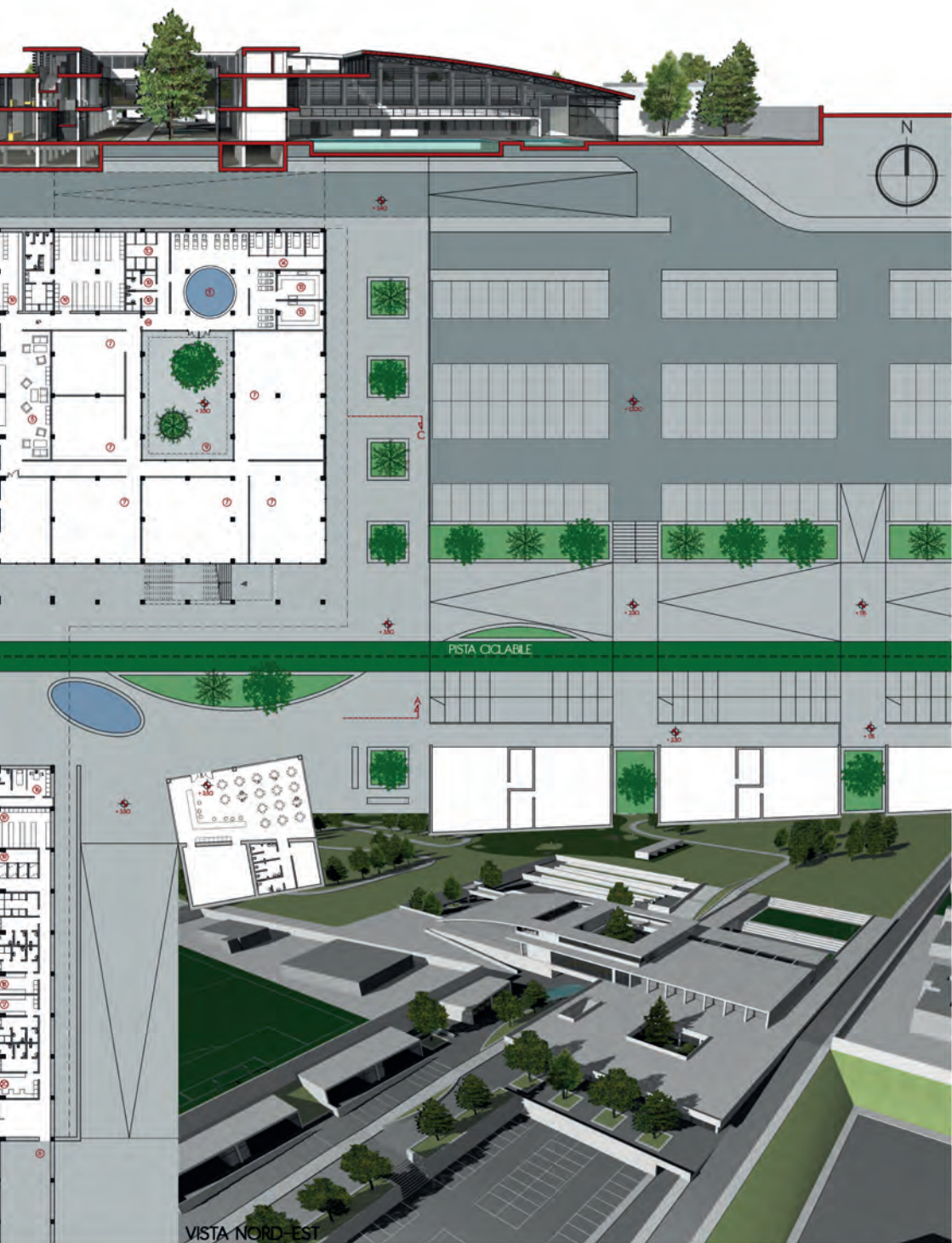
Francesco Boccia e Rachele Palladino, Progetto di un centro sportivo lungo via Casilina a Roma. Pianta del piano terra, sezione trasversale, viste prospettiche e layout funzionale del complesso.
